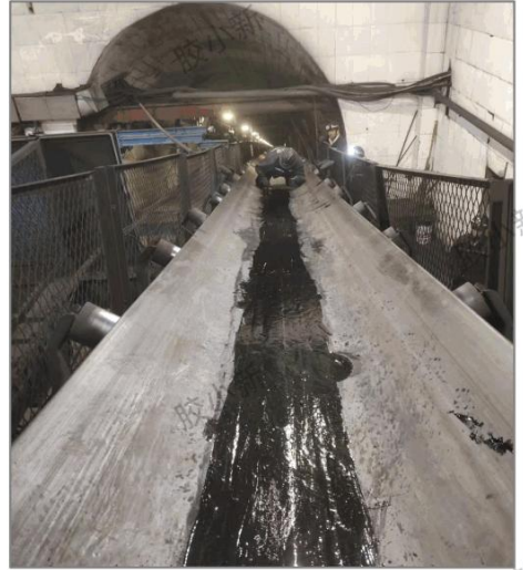
某煤矿200米边缘损伤修复
